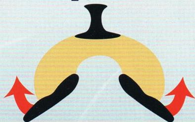
Unser neu entwickelter ScapuFlex<sup>®</sup> (Pat. angem.) Sattelbaum ist so konstruiert und gefertigt, dass die Bars vorne weicher sind und bei stärkerer Druckbelastung ausweichen können.
